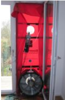
Balkontür mit Ventilator zur Überprüfung der Luftdichtheit (Blower-Door-Test)
